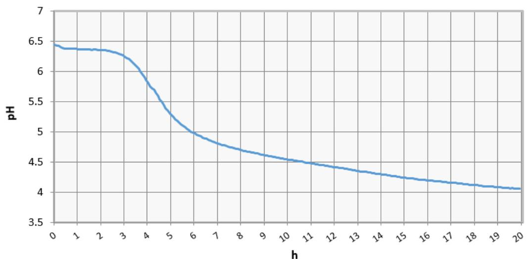
Medium: rekonstituierte Pulvermagermilch, sterilisiert; Impfmenge: 1 ‰; Bebrütungstemperatur: 38°C
