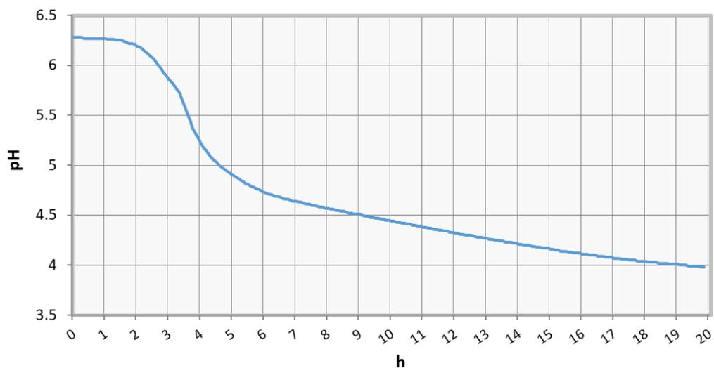
Medium: rekonstituierte Pulvermagermilch, sterilisiert; Impfmenge: 1 ‰; Bebrütungstemperatur: 38°C
